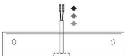
**IT** Aprire la scatola porta morsetti (4) e connettere i cavi ai morsetti. Inserire i cavi sporgenti dal soffitto attraverso la protezione in gomma e coprirli completamente. Connettere i cavi al morsetto.
