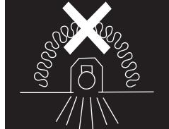
**DNK** - Lampen må ikke tildekkes med isolermateriale.
